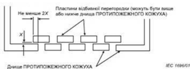
Рисунок 4F - Конструкція відбивної перегородки
