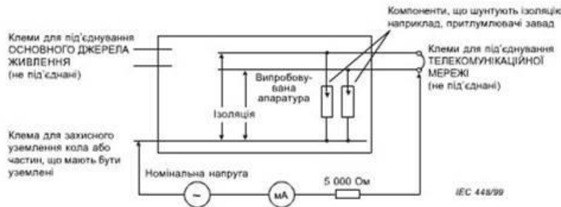
Рисунок 6А - Схема для випробовування відокремлення телекомунікаційної мережі від уземлення
