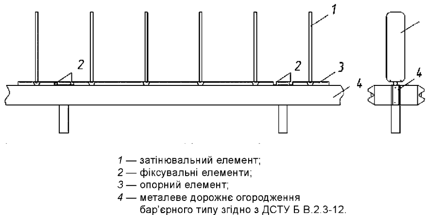
Рисунок 2 — Приклад установлення ЕП
