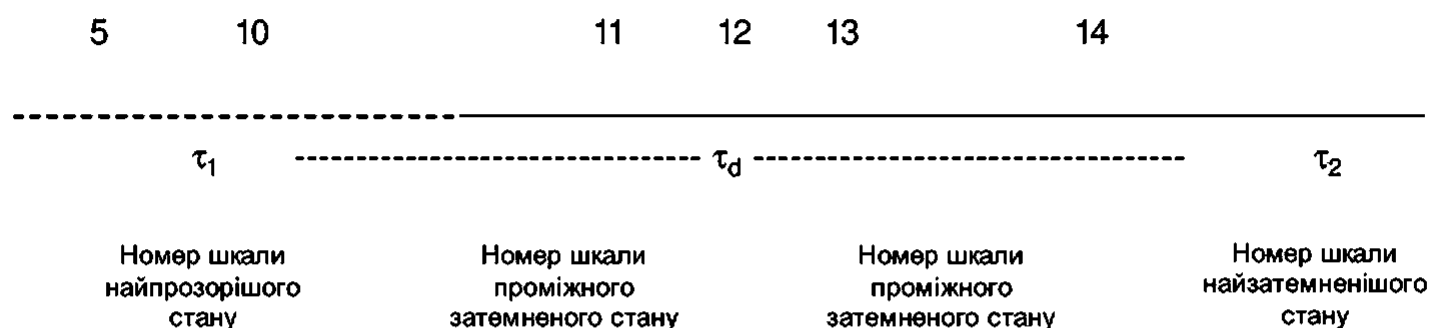
Рисунок 1 — Приклад, що показує значення термінів у разі автоматичного зварювального фільтра з номером шкали прозорого стану 5 і номерами шкали затемненого стану між 10 і 14
