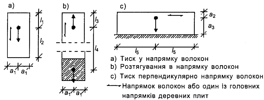
Рисунок 2 — Розміри зразків відповідно до таблиці 1
