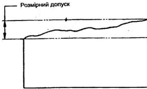
Рисунок В.3 — Відхилення паралельності дорівнюють числовій величині допуску на розмір
