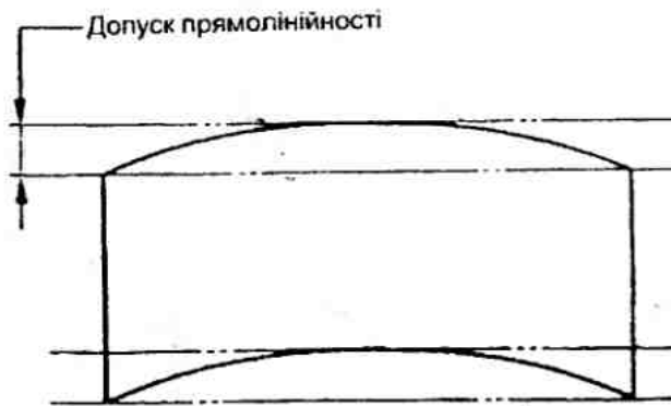
Рисунок В.4 — Відхилення паралельності дорівнюють числовій величині допуску прямолінійності
