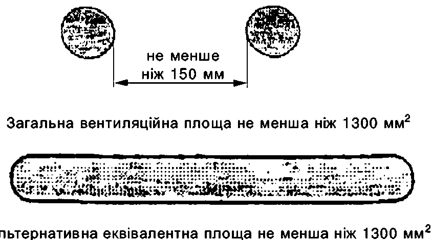
Рисунок 6 — Приклад еквівалентної окремої вентиляційної площі
