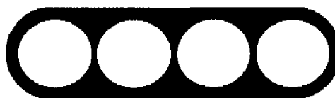
Рисунок 2 — Поперечний переріз типового стрічкового елемента із повним покриттям оптичних волокон клейовою речовиною
