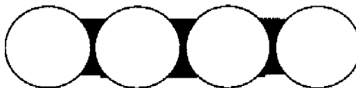
Рисунок 1 — Поперечний переріз типового стрічкового елемента із повздовжньою адгезією країв волокна
