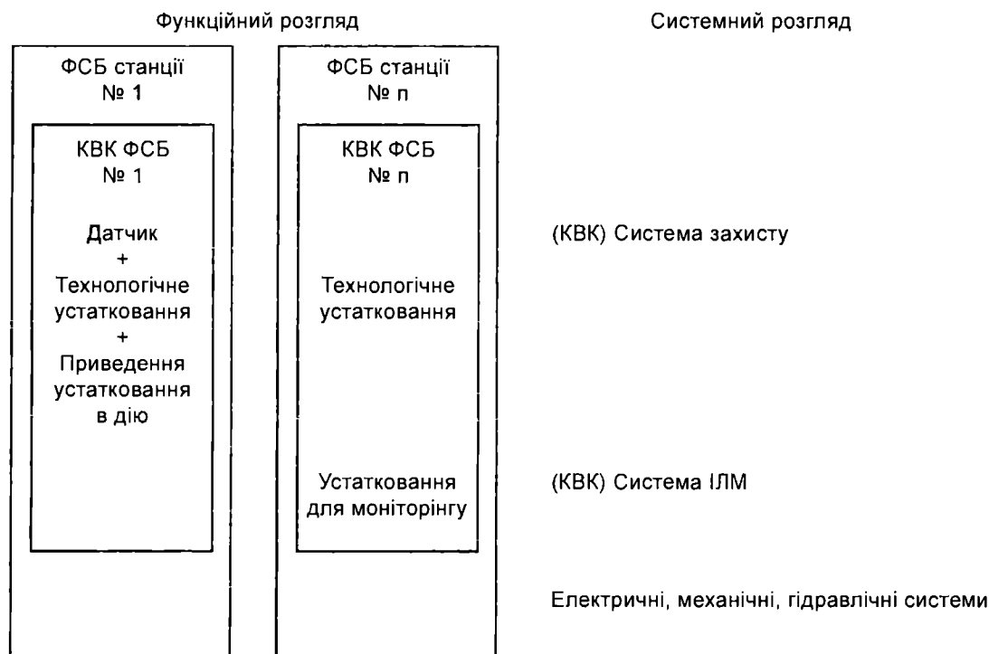
Рисунок В.1 — Взаємозв'язок між КВК-функціями та КВК-системами
