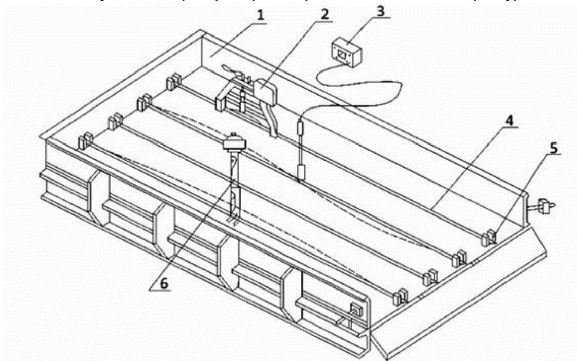
1 - форма; 2 - прибор ПИН; 3 - прибор ИПН-7; 4 - арматура; 5 - упоры; 6 - прибор ПРДУ
