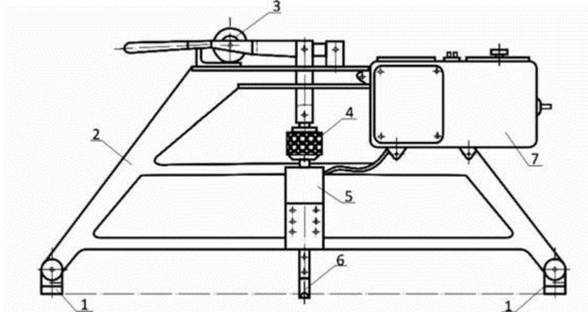
1 - упоры; 2 - рама; 3 - эксцентрик; 4 - регулировочная гайка; 5 - упругий элемент с проволочными тензорезисторами (размещается под кожухом); 6 - крючок; 7 - коробка с элементами электрической схемы
