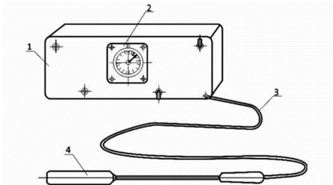
1 - корпус прибора; 2 - счетчик; 3 - провод; 4 - первичный преобразователь
