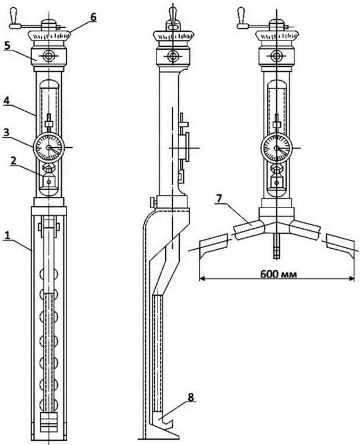
1 - упор; 2-пружина; 3-индикатор; 4- корпус; 5-шарнир; 6-лимб с ручкой; 7-собственная база; 8-крюк
