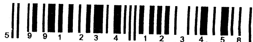
Рисунок 5 — Загальний вигляд штрихового Коду EAN-13 (кодовий рядок 5991234123458)
