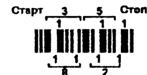
Рисунок 4 — Подання числа 3852 штриховим кодом ІТФ
