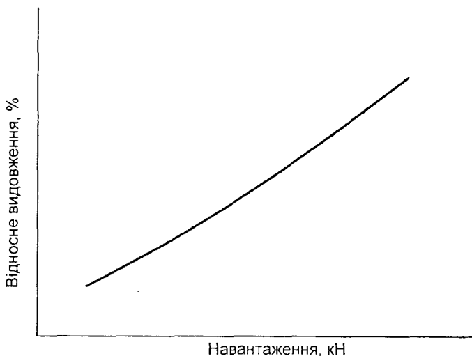
Рисунок НА.5 — Ізохронна крива «відносне видовження—навантаження» за заданим часом t
