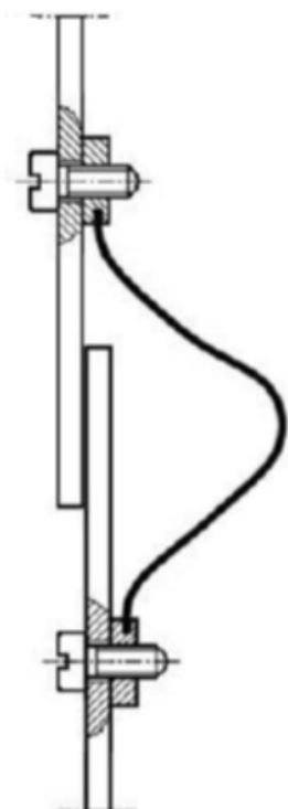
Рисунок Е.35а — Сполучення гнучкою металевою стрічкою
