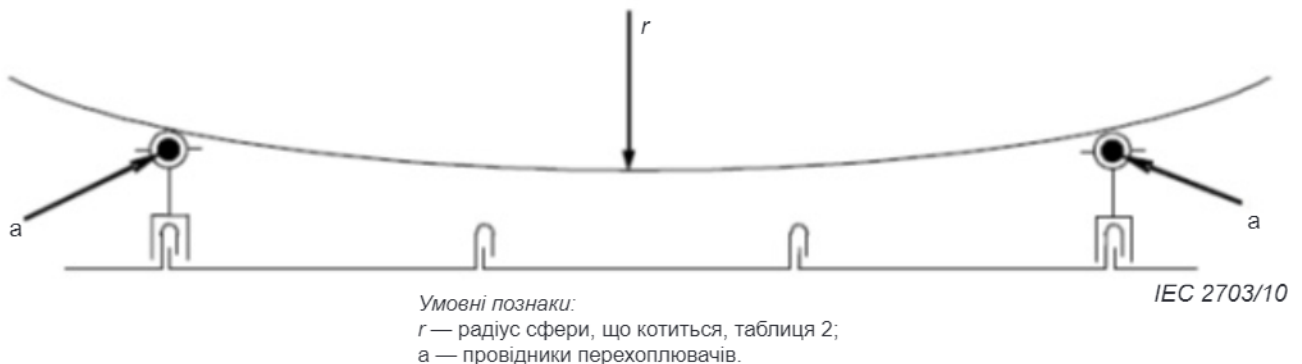
Рисунок Е.26 — Конструкція мережі перехоплення на покрівлі зі струмопровідним покриттям, де проколювання покриття є неприйнятним
