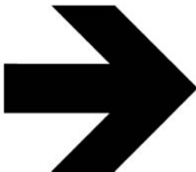
Рисунок 1 — Стрілка, яка вказує напрямок руху людей (ISO 3864-3, стрілка типу D)
