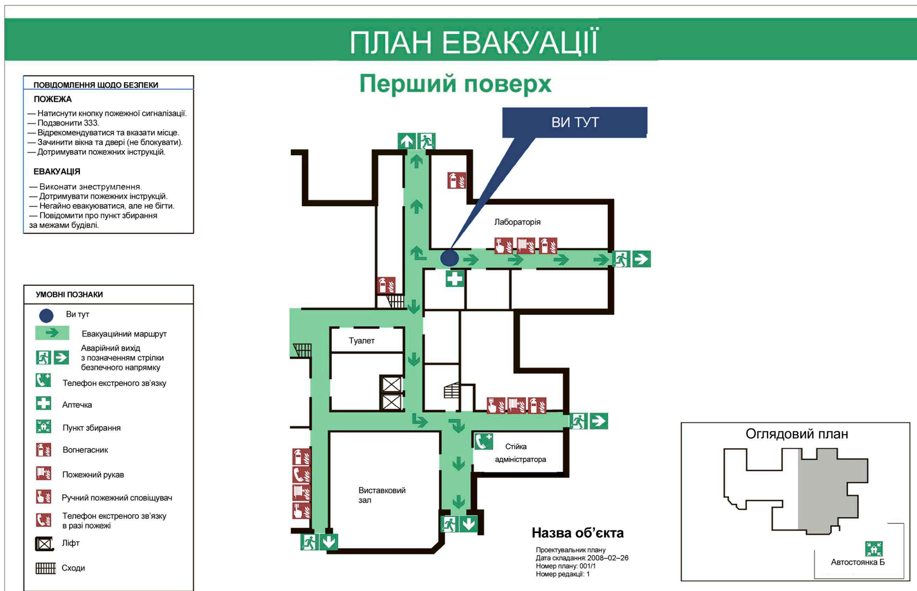
Рисунок А.3 — Приклад плану евакуації. Частина поверху
